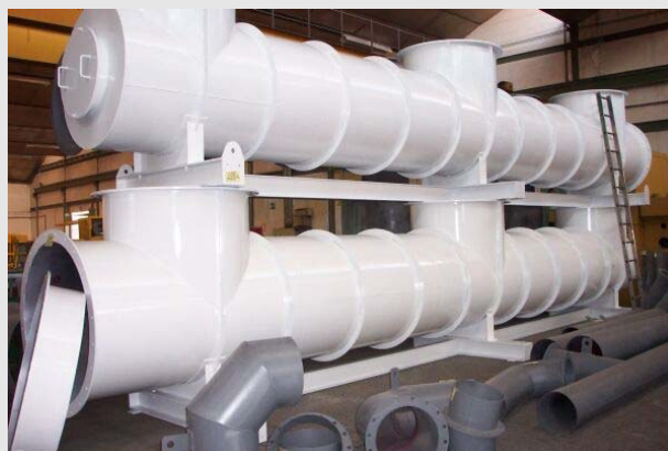
Conduits d'entrée et de sortie
