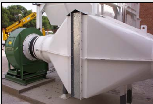
Filtre à particules
